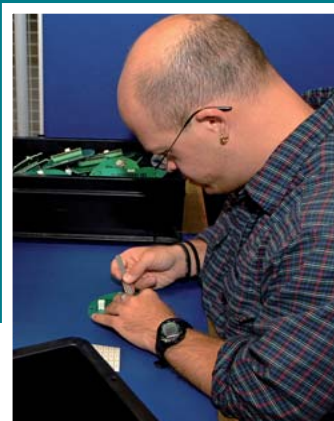
Qualitätssicherung: Jedes Bauteil wird zur Rückverfolgung sorgfältig nummeriert.
