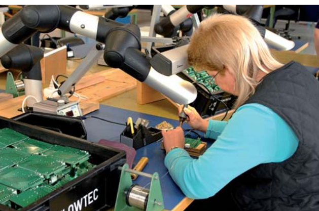
Anspruchsvolle Aufgabe: Das Löten von Leiterplatten erfordert viel Geschick.
