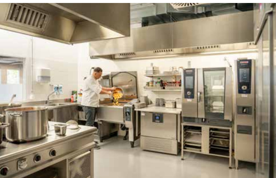
Der Rational iVario Pro L mit einem Fassungsvermögen von 100 Litern ist Kipper, Kessel und Druckgarer in einem.
